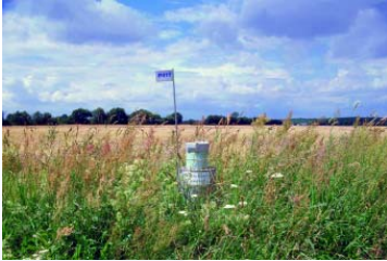
Grundwasser messstelle im Trinkwasserschutzgebiet Canitz/Thallwitz
