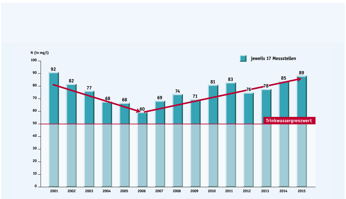
Messwerte des Wasserwerks Thülsfelde: Mittlerer Nitratgehalt (mg/l) im noch jungen, oberflächennahen Grundwasser unter landwirtschaftlich genutzten Flächen im Wasserschutzgebiet Thülsfelde. Die Messungen erfolgten bis max. fünf Meter unterhalb der Grundwasseroberfläche. Das Grundwasser für die Trinkwasseraufbereitung wird in tieferen Schichten gewonnen. Der zulässige Trinkwassergrenzwert liegt bei 50 mg/l. – Quelle: Oldenburgisch-Ostfriesischer Wasserverband
